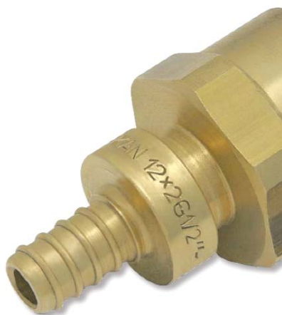
Rys. 3. Bezoringowa złączka Push z gwintem 1/2" do rur o średnicy 12 x 2 mm
