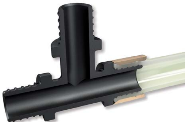
Rys. 2. Połączenia KAN-therm Push charakteryzują się niewielkimi oporami przepływu ze względu na małą różnicę wewnętrznych średnic rury i złączki
