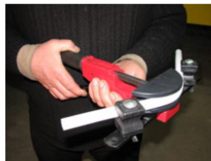
Gięcie rury wielowarstwowej za pomocą giętarki do rur z tworzywa sztucznego
