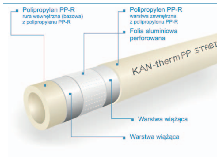
rys. Budowa rury zespolonej KAN-therm PP Stabi Al
