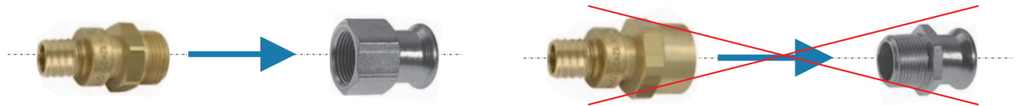
rys. Zasada łączenia elementów KAN-therm z gwintami
