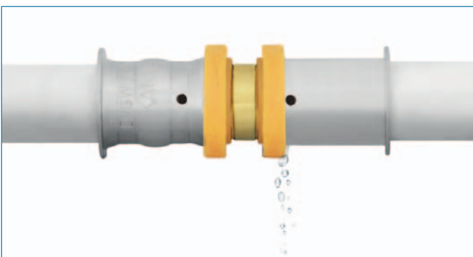
rys. Działanie funkcji LBP – wyciek przed zaprasowaniem
