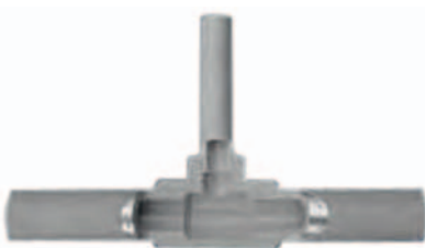
rys. Przekrój połączenia zgrzewanego
