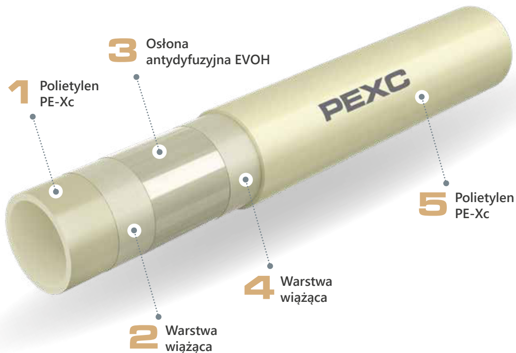
Przekrój rury PEXC z osłoną antydyfuzyjną
