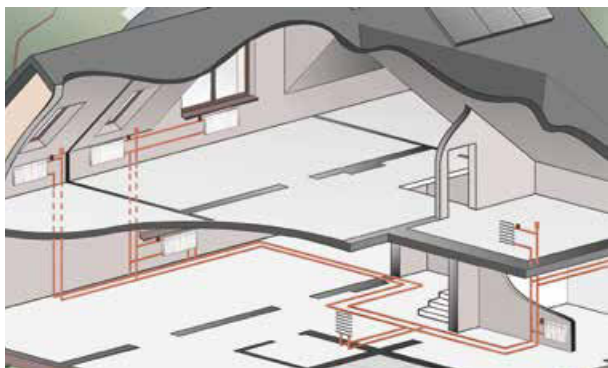
Układ „pionowy” instalacji grzewczej
