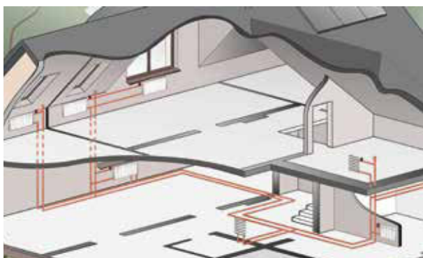
Układ „pionowy” instalacji grzewczej
