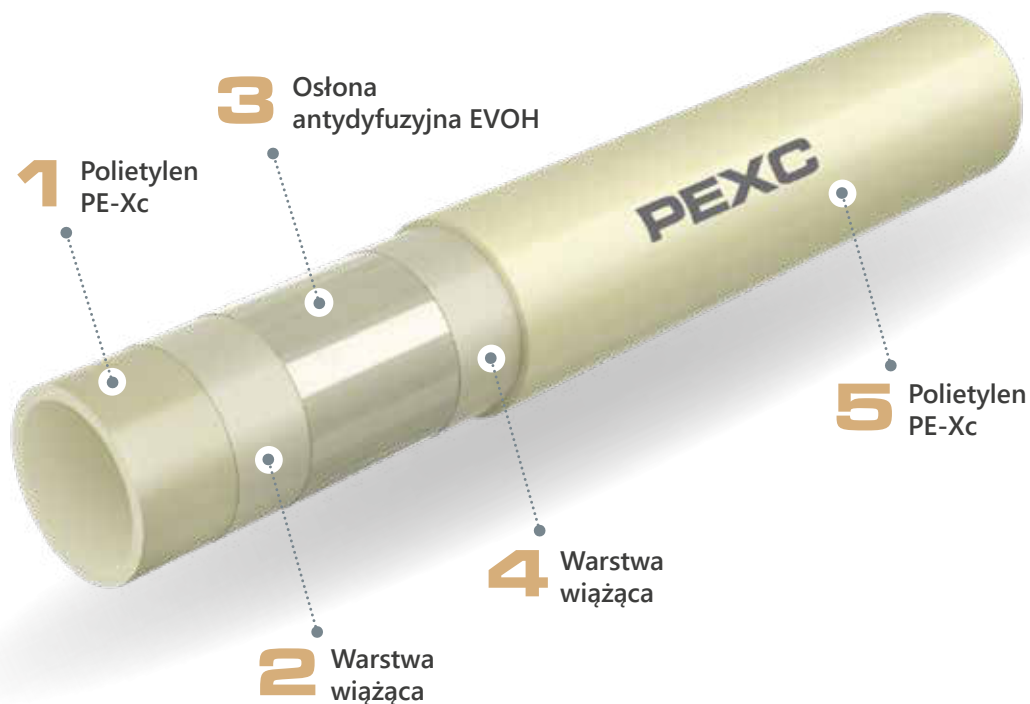
Przekrój rury PEXC z osłoną antydyfuzyjną
