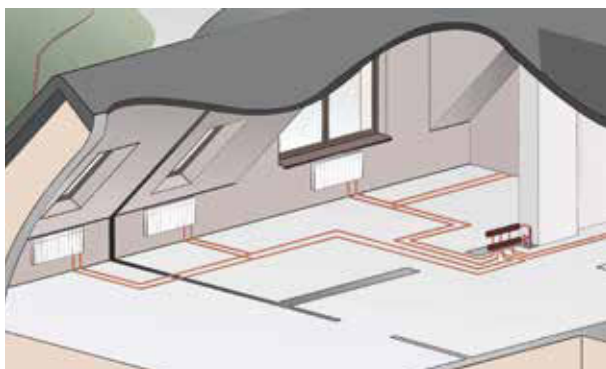
Układ rozdzielaczowo-trójnikowy w instalacji grzewczej
